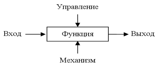
Рис.1. Блок функциональной модели
