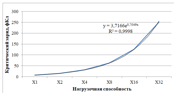
Рис. 10. Зависимость критического заряда от нагрузочной способности ячейки INV при входном воздействии равном логическому нулю
