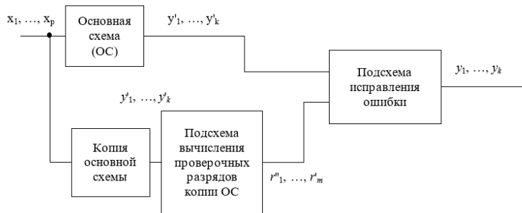
Рис. 2. Структура СФК на основе низкоплотного кода с подробным указанием подсхем входящих в состав корректирующей схемы
